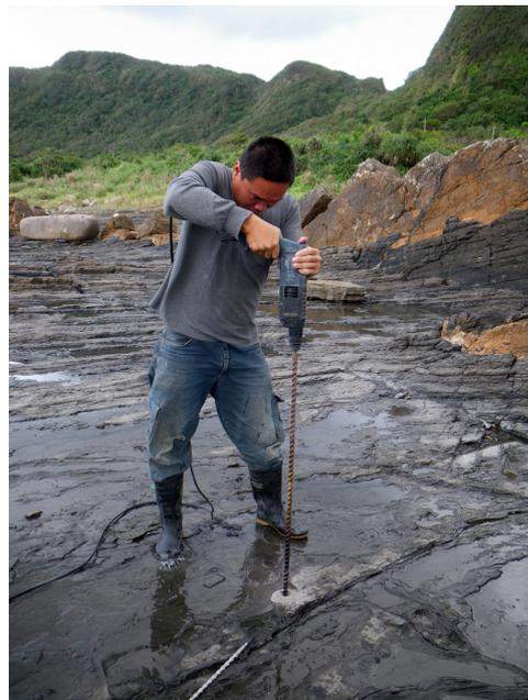
圖 5.47 藉由鑽孔來判斷斷層 IX 的位態。(a) 斷層 IX 傾角計算作圖，藍色星星分別代表鑽孔 A、鑽孔 B (b) B 點的鑽孔過程。
