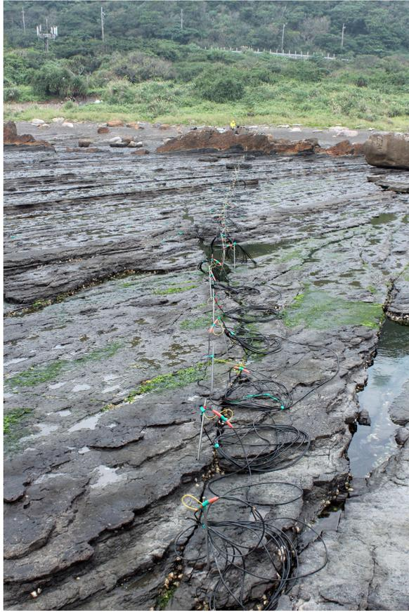
圖 4.6 地電阻施測情形，以 L2 測線的施測情形為例，每根電極的間距為一米。
